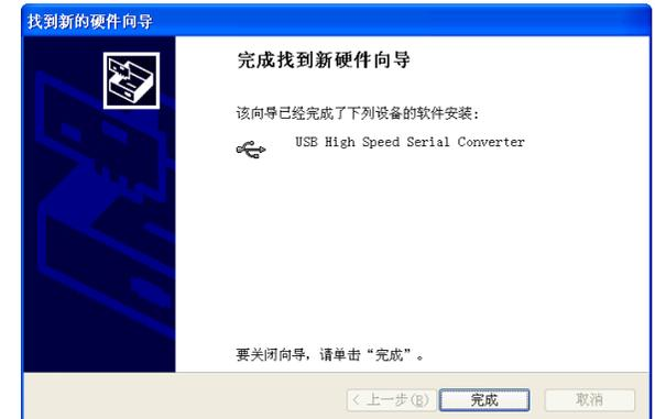
这是完成了安装转换器的第一个步骤, 第二个步骤涉及到安装串口。一旦转换器的安装正确完成后, 串口会自动的安装在系统中。
