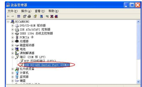
当串口正确安装完成后, 在系统属性界面下的设备管理器中, 会看到 USB 设备已经显示在设备管理器中, USB RS-485 Serial Converter (COM2), USB 串口像普通串口一样编程使用。要改变虚拟的串口属性, 那么就选择 USB Serial Port, 然后用鼠标右键单击。这个操作允许进行对串口诸如波特率、停止位、校验位等属性的改变。
